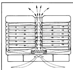
**Opis:** Suszarki się składają z bazy (podstawy) urządzenia (wewnętrznie znajduje się wentylator, grzałka, regulator elektroniczny i przewód zasilający), sit, pokrywy i akcesoriów.
